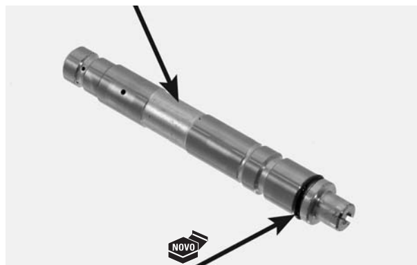
ANEL DE VEDAÇÃO CONJUNTO DO CONTRAPESO DO BALANCEIRO
